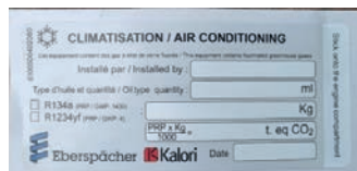
Fig. 131: Autocollant avec informations sur l'air conditionné
